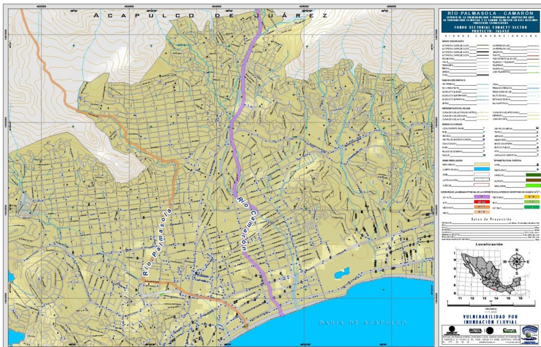
Figura 19. Áreas de inundación fluvial de los ríos Palmasola y Camarón en el destino turístico de Acapulco
