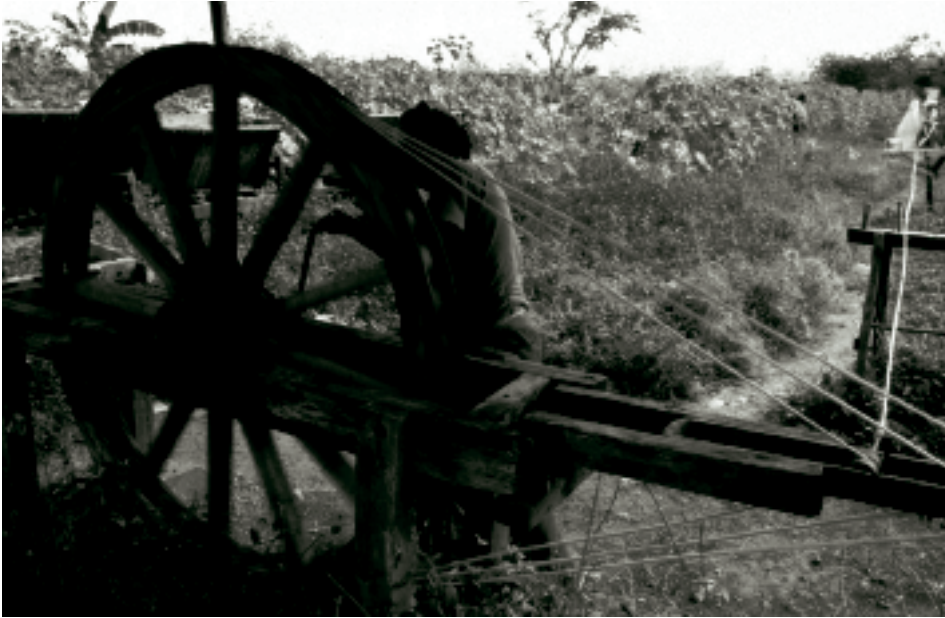
Utilizan una rueda de madera para hacer mecate de fibra de henequén. Zacapu, Yucatán. Fotógrafo: Ricardo Moura, 1981. Fototeca Nacho López, CDI.
