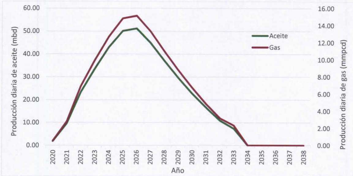
Figura 8 Pronóstico de producción de aceite y gas, Escenario Incremental. (Fuente: CNH con datos de Pemex)
