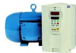
Instalar motores de velocidad ajustable con reguladores electrónicos, en aquellos accionamientos, en los que la carga sea variable y se pueda controlar ajustando la velocidad. Por ejemplo, en sistemas de bombeo o compresión que deben suministrar caudales variables y que para hacerlo utilicen válvulas u otros dispositivos de control. La eficiencia total del motor y su carga se eleva notablemente, con ahorros importantes de energía.
