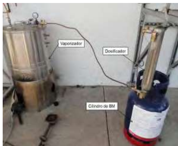
Imagen 1. Uso del evaporador en la aplicación de bromuro de metilo.
