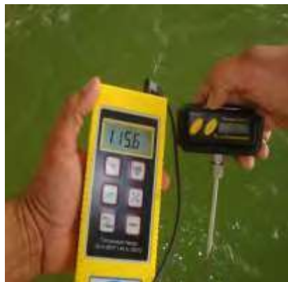
Figura H-06. Calibración de sensor portátil con base al termómetro certificado.
