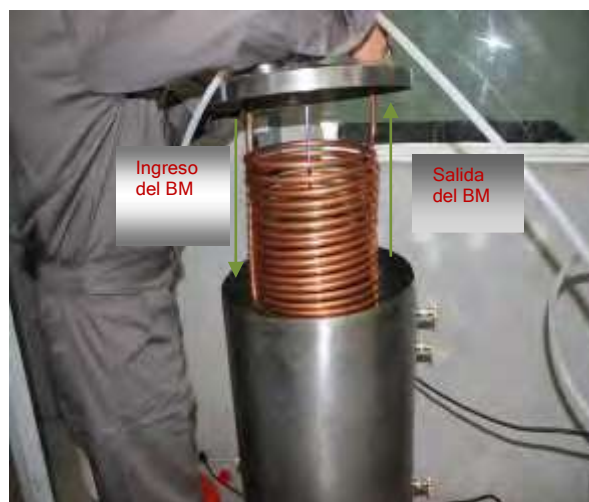
Imagen 2. Serpentín en el interior del evaporador.
