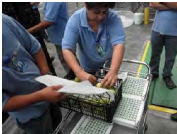
Figura I-03.- Colocación de dosímetros durante las pruebas de mapeo.
