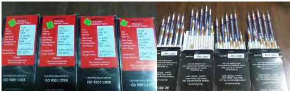
Figura BM-03.- Tubos colorimétricos para bromuro de metilo, de rango bajo (1-18 ppm).
