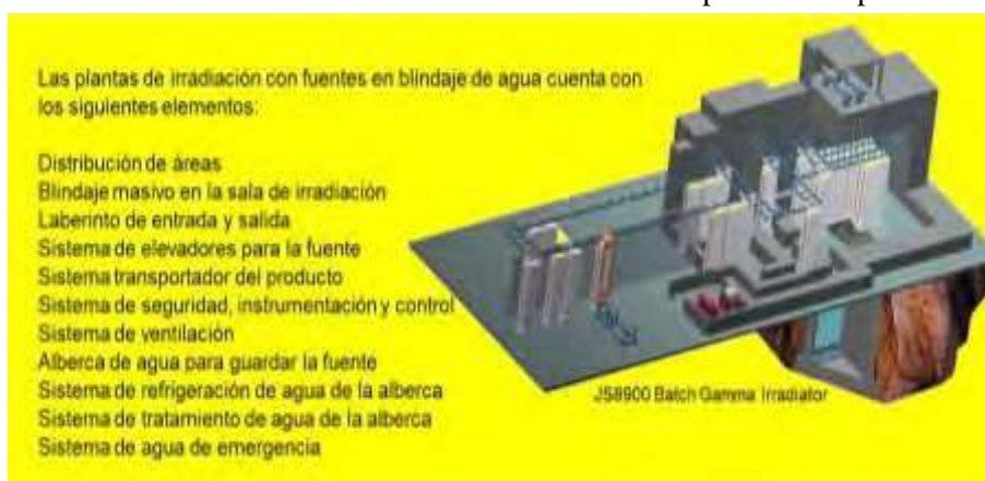
Figura I-01.- Elementos generales de una planta de irradiación.
