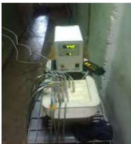
Imagen 12. Calibración de sensores con base al termómetro certificado
