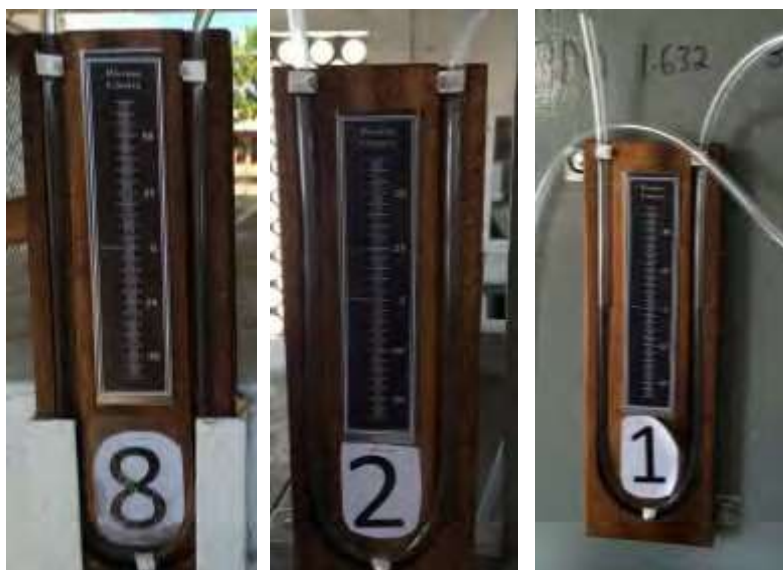
Imagen 5. Manómetros de brazo abierto "hechizos" ubicados en cada cámara de fumigación.
