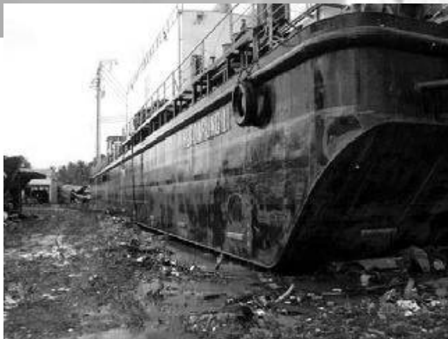
Fig. 47. Barco portador de una planta de generación de electricidad, con longitud de 75 m y línea de flotación de 3 m, hallado a 3 km de la costa en el área urbana de Banda Aceh. Fuente: CENAPRED
