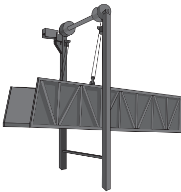
a) rampa de descarga de animales ESTRUCTURA DE ACERO Y PAREDES DE LÁMINA DE ACERO, PLATAFORMA DE TRÁNSITO EN ALUMINIO ANTIDERRAPANTE
