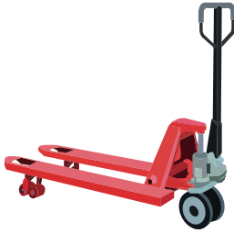
c) patin hidráulico de fabricación robusta con capacidad de cinco toneladas con horquilla, caja, lanza, bomba y ejes de acero inoxidable pulido, brazos basculantes y barras de presión
