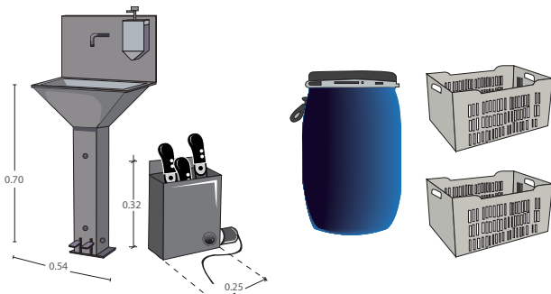
c) lavamanos de pedal con accionado de pie o rodilla DE ACERO INOXIDABLE, CENTRO DE DRENAJE
