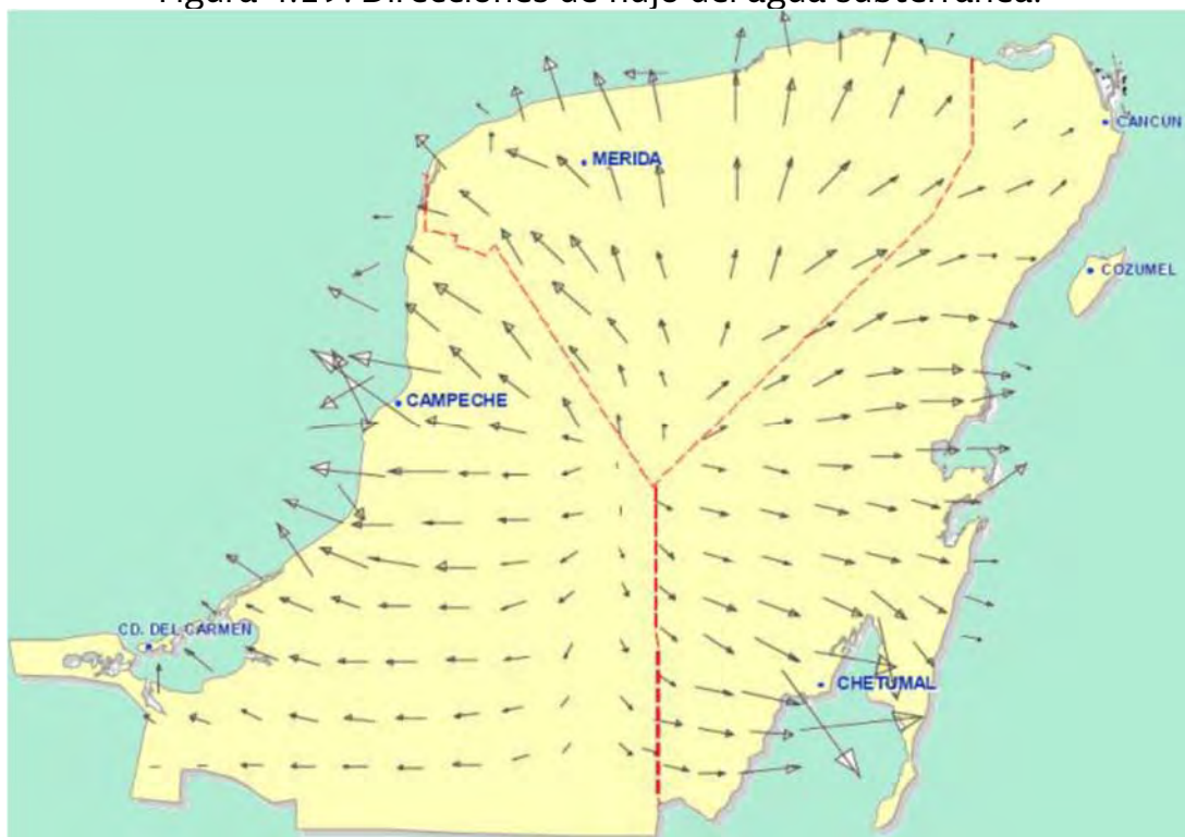
Figura 4.19. Direcciones de flujo del agua subterránea.
