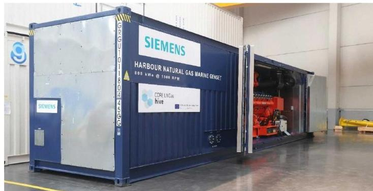
Figura 8: Contenedor alimentado por LNG para dar electricidad (Fuente: Suardiaz)
