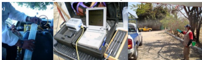
Foto 1. a) Medición de tasa de descarga por minuto, b) Equipo DC IV, c) Medición tamaño de gota
