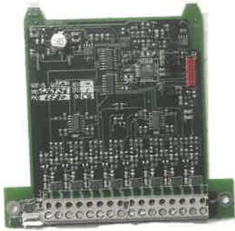
**Figura 1.15.** Módulo expansor de zonas para central de alarmas. (Cortesía de Panasonic).
