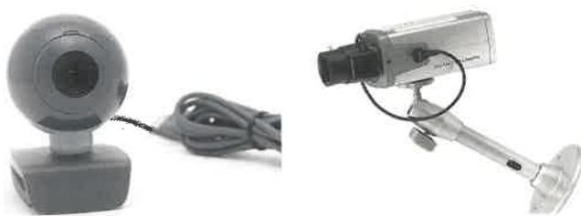
**Figura 7.46.** Cámaras IP, diseñadas para emitir las imágenes captadas directamente a la red (internet o red local).
