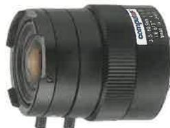
**Figura 7.10.** Objetivo CCD 1/3", distancia focal de 3,5-10,5 mm y apertura f1.0.
