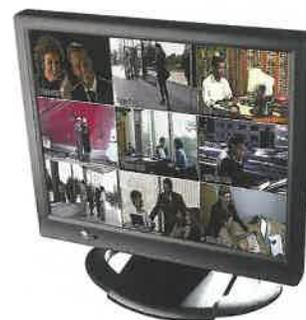
Figura 7.45. Visualización en una pantalla de 19" de la imagen ofrecida por un multiplexor de 9 canales ( $3 \times 3$ ).
