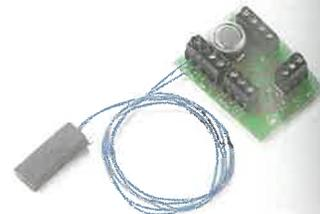
**Figura 7.27.** Calefactor con termostato.
