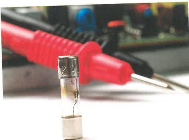
**Figura 1.21.** La reposición de elementos fungibles, como por ejemplo los fusibles de protección, forma parte del mantenimiento correctivo.
