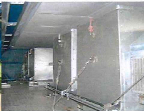
Figura 39. Cajas de liberación acoplada a la máquina de liberación en la aeronave.
