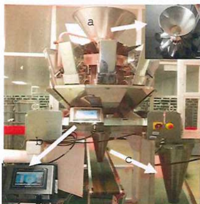
Figura 23. Equipo de dosificación en el área de empaque. a) Tolva central y tolvas de pesaje, b) programador digital, c) embudo
