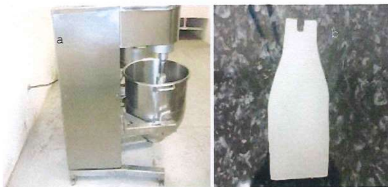
Figura 8. Equipo utilizado en la preparación de la mezcla. a) batidora, b) espátula
