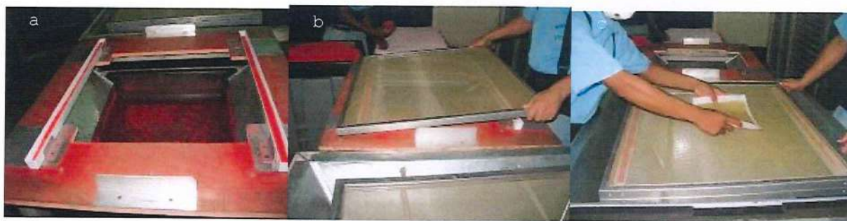
Figura 12. Proceso de armado de cribas.
