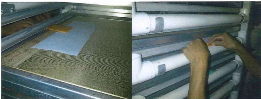
Figura 17. Colocación de pellium y esponja.
