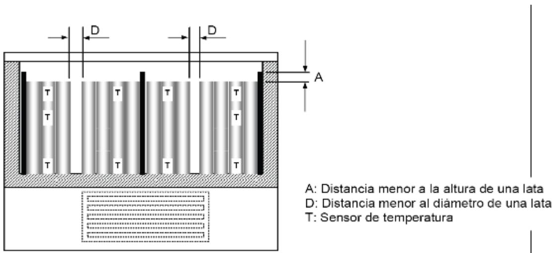
**E.4.2** Los sensores deben ser colocados en latas de las columnas adyacentes a aquellas que están en contacto con las placas frías, como se ejemplifica en las figuras anteriores y siguientes:
