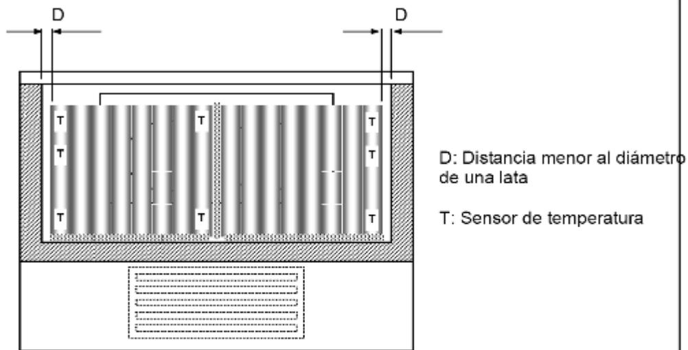
Para equipos con más de 5 niveles, intercalar los sensores colocando cada dos niveles 1 sensor en el centro del equipo, comenzando por el nivel superior.
