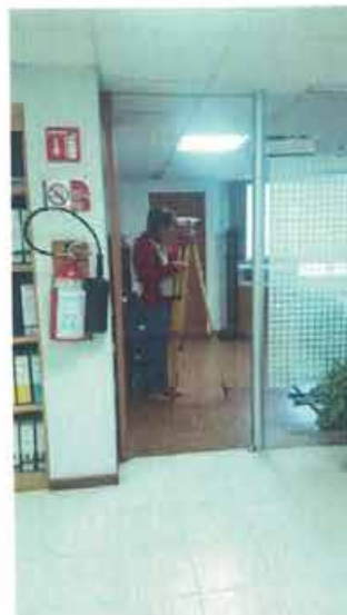
NIVELACIÓN DE PUNTOS DE CONTROL Nivelación de puntos de control con nivel fijo marca LEICA.
