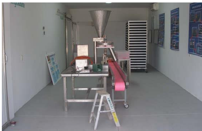
Figura 5. Banda transportadora y dosificador mecánico
