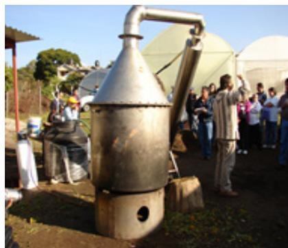
Figura 11. Quemador, mangueras de entrada y salida de agua al destilador, tubo de salida del aceite condensador.
