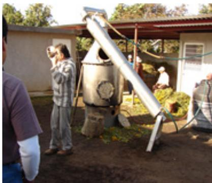
Figura 10. Partes del equipo de destilación: olla, tapa, condensador, bomba de agua y tanque de gas.
