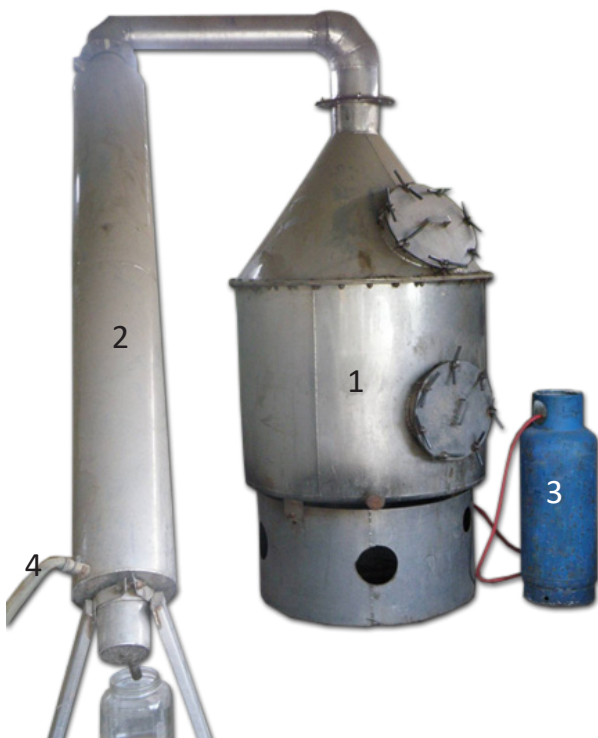
Figura 8. Equipo de destilación para pruebas piloto de extracción de aceites esenciales de T. lemmonii . Olla (1), Condensador (2), Fuente de calor (3), Fuente de enfriamiento (4).
