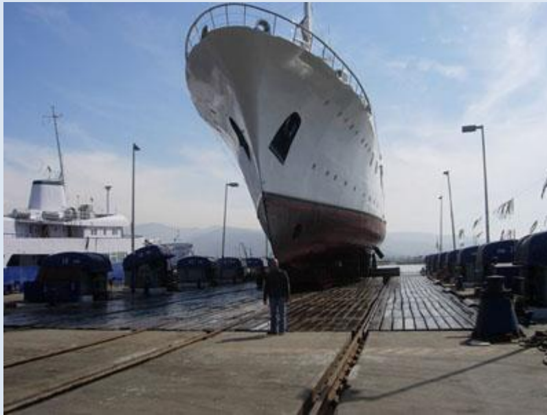
Embarcación puesta en seco por medio del sincroelevador Imagen obtenida de la web de la empresa
