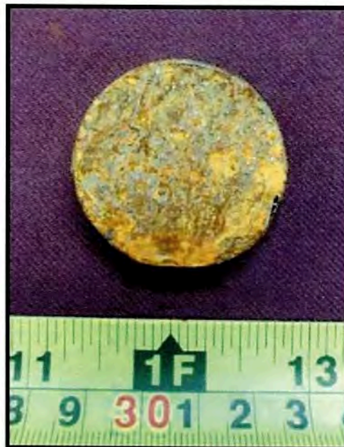
Fotografía 8. Aspecto general de la muestra 16ME303 después de 120 h de ensayo en cámara salina
