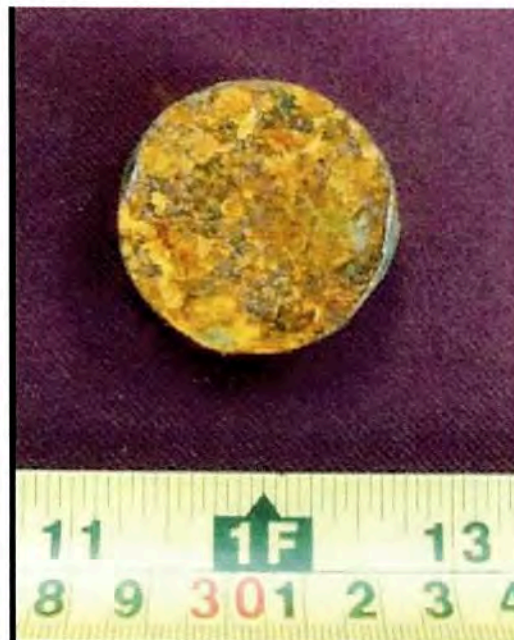
Fotografía 14. Aspecto general de la muestra 16ME305 después de 72 h de ensayo en cámara salina
