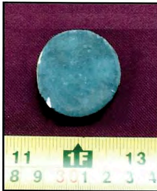
Fotografía 9. Aspecto general de la muestra 16ME304 antes del ensayo en cámara salina.
