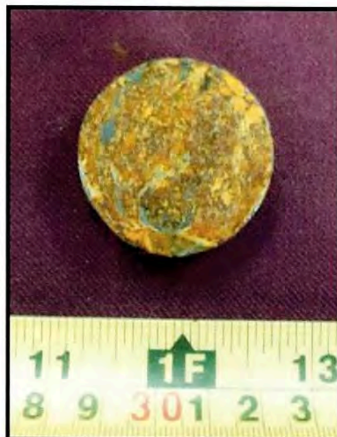
Fotografía 10. Aspecto general de la muestra 16ME304 después de 72 horas de ensayo en cámara salina
