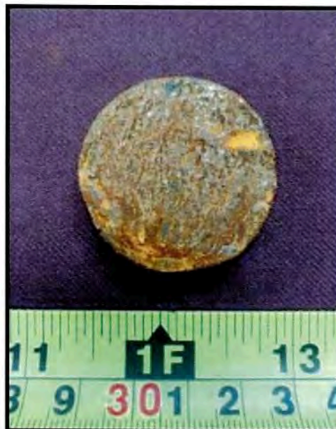
Figura 4. Aspecto general de la muestra 16ME302 después de 120 h de ensayo en cámara salina
