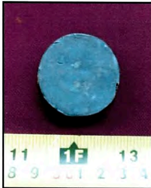
Fotografía 5. Aspecto general de la muestra 16ME303 antes del ensayo en cámara salina.
