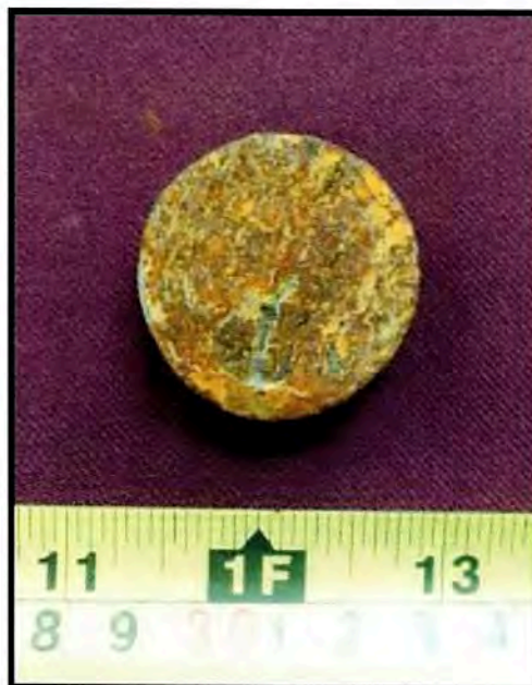
Fotografía 11. Aspecto general de la muestra 16ME304 después de 96 h de ensayo en cámara salina.
