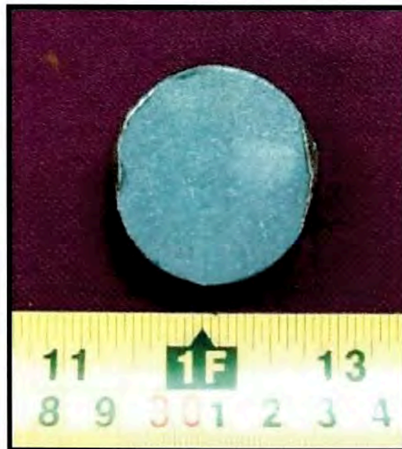
Fotografía 13. Aspecto general de la muestra 16ME305 antes del ensayo en cámara salina.
