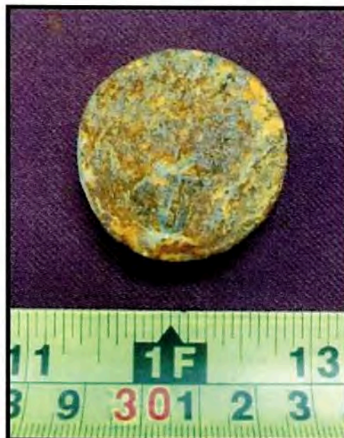
Fotografía 12. Aspecto general de la muestra 16ME304 después de 120 h de ensayo en cámara salina.
