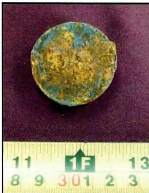
Fotografía 18. Aspecto general de muestra 16ME306 después de 72 h de ensayo en cámara salina
