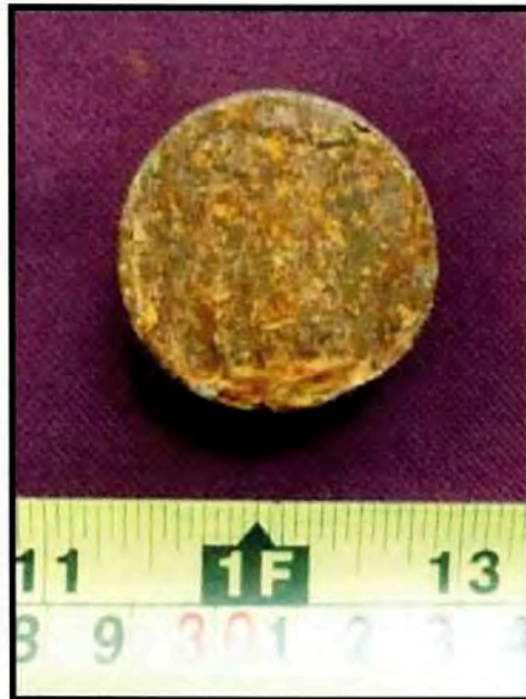
Fotografía 23. Aspecto general de la muestra 16ME307 después de 96 h de ensayo en cámara salina.
