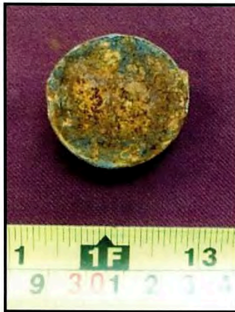
Fotografía 19. Aspecto general de la muestra 16ME306 después de 96 h de ensayo en cámara salina.
