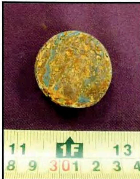
Fotografía 22. Aspecto general de la muestra 16ME307 después de 72 h de ensayo en cámara salina.
