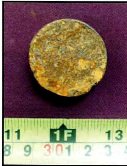
Fotografía 7. Aspecto general de la muestra 16ME303 después de 96 h de ensayo en cámara salina.
