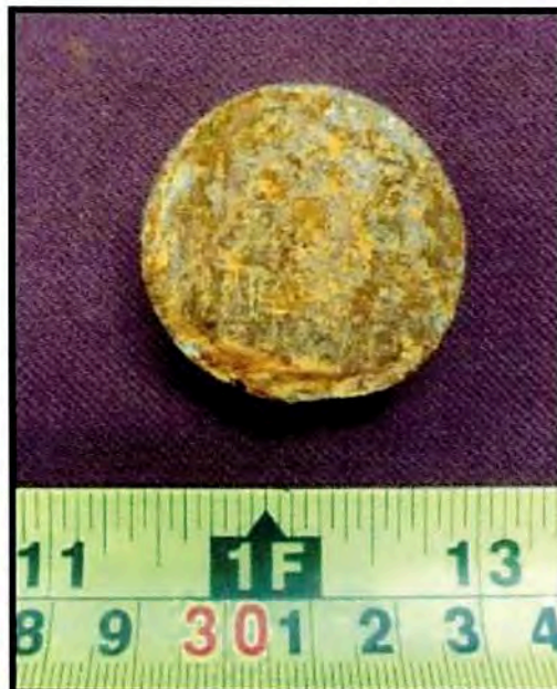
Fotografía 24. Aspecto general de la muestra 16ME307 después de 120 h de ensayo en cámara salina.
