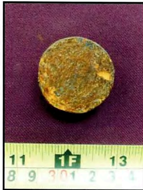
Figura 3. Aspecto general de la muestra 16ME302 después de 96 h de ensayo en cámara salina.
