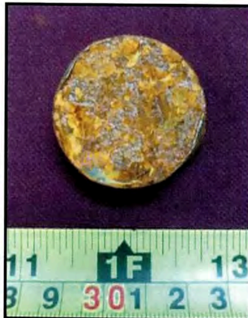
Fotografía 16. Aspecto general de muestra 16ME305 después de 120h de ensayo en cámara salina.
