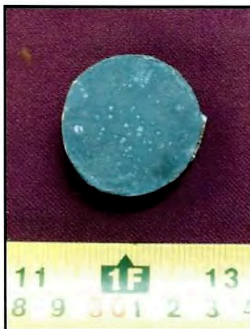
Fotografía 17. Aspecto general de la muestra 16ME306 antes del ensayo en cámara salina.
