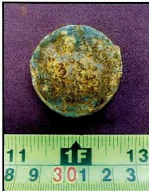
Fotografía 20. Aspecto general de la muestra 16ME306 después de 120 h de ensayo en cámara salina.
