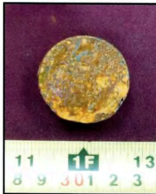
Fotografía 6. Aspecto general de la muestra 16ME303 después de 72 h de ensayo en cámara salina
