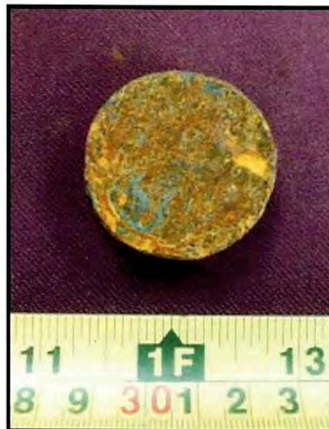
Fotografía 2. Aspecto general de la muestra 16ME302 después de 72 h de ensayo en cámara salina.
