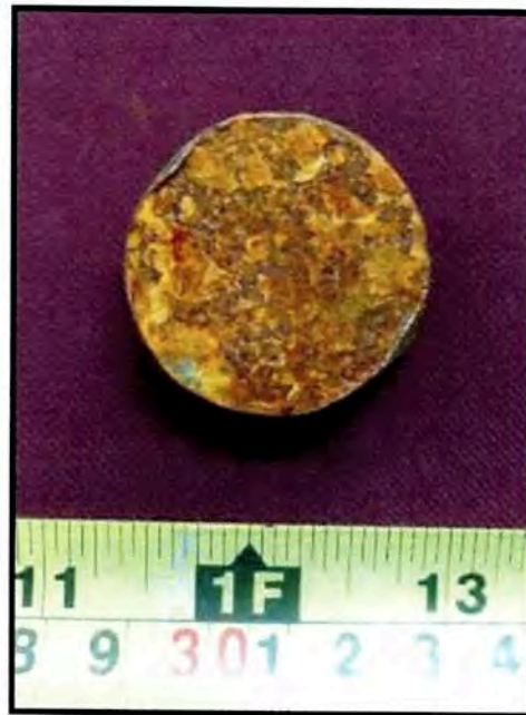
Fotografía 15. Aspecto general de muestra 16ME305 después de 96 h de ensayo en cámara salina.
