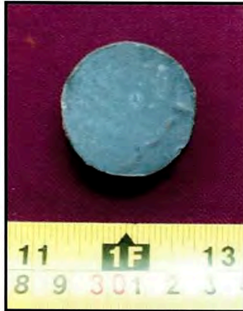
Fotografía 1. Aspecto general de la muestra 16ME302 antes del ensayo en cámara salina
