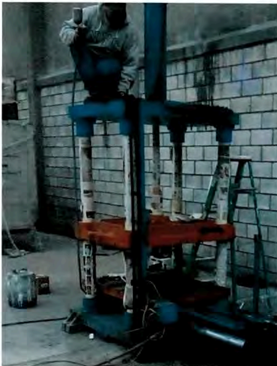
Armado de soporte de equipo de moldeo por transferencia
