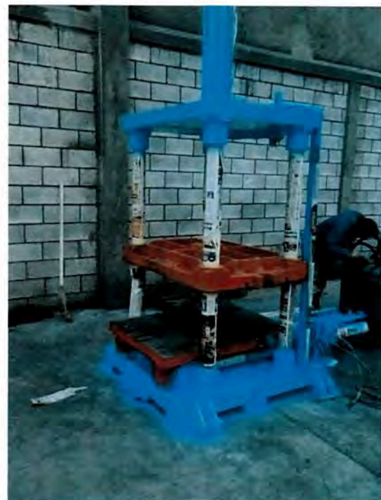
Armado de soporte de equipo de moldeo por transferencia
