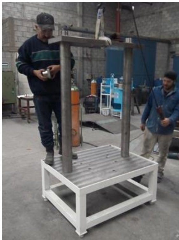
Construcción de sistema de sujeción de válvulas de modo superior e inferior
