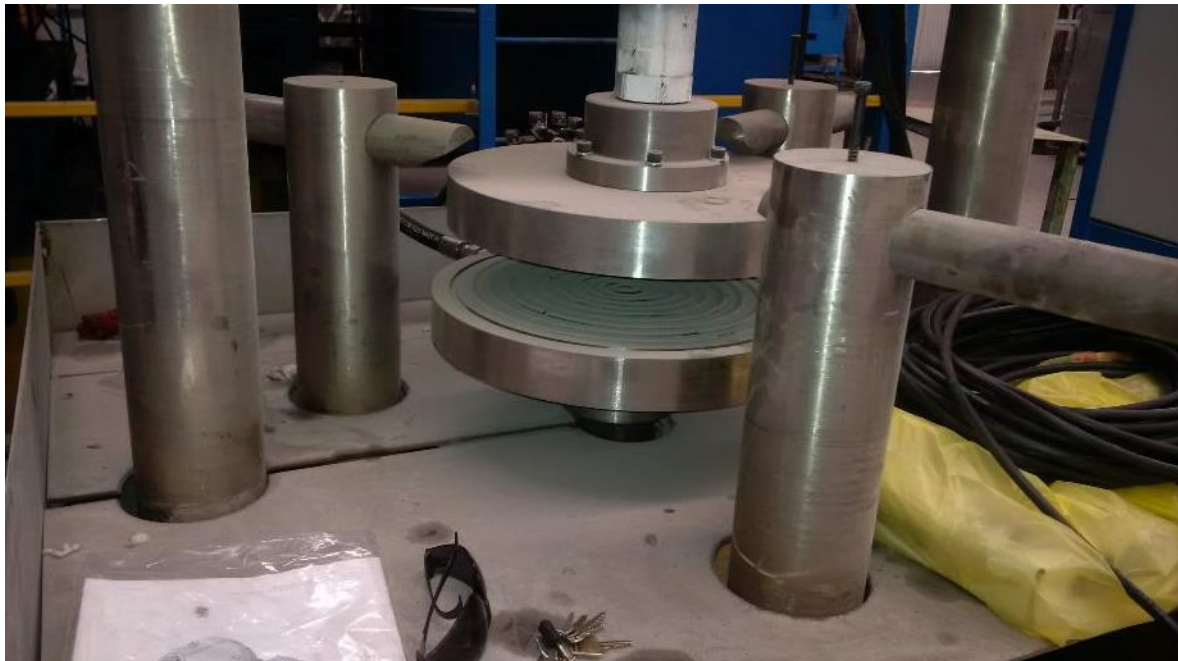
Sistema de sujeción de válvulas
