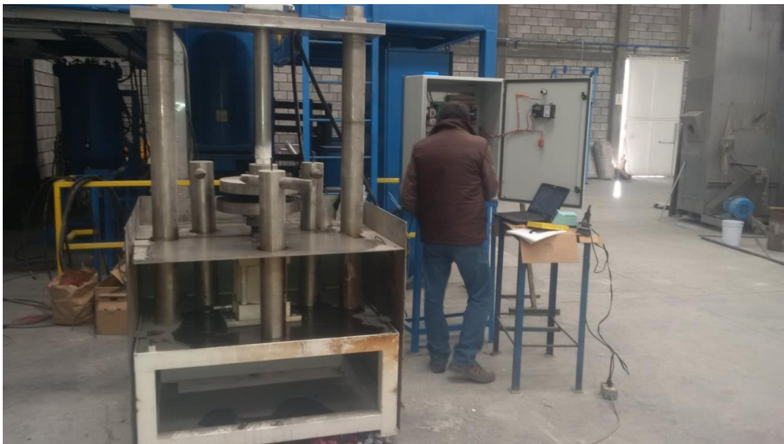
Sistema de control de banco de pruebas de hasta 12" y 270 lbs/pug 2
