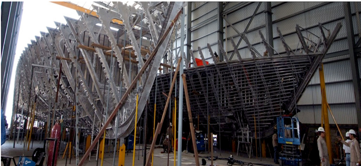
IMAGEN 86: CONSTRUCCIÓN DE DOS EMBARCACIONES DE ALUMINIO DENTRO DE LA NAVE INDUSTRIAL
