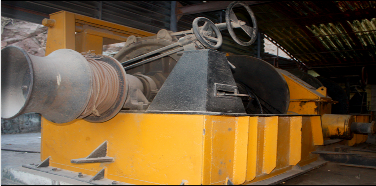
IMAGEN 77: WINCHE UTILIZADO PARA DAR EL TIRÓN A LAS EMBARCACIONES EN EL VARADERO.
