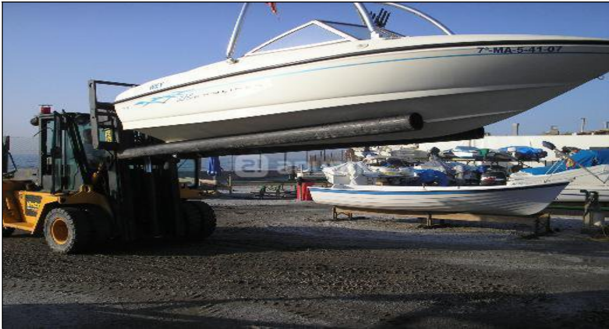
IMAGEN 37: PUESTA EN SECO Y TRANSPORTE DE UNA EMBARCACIÓN DE RECREO.
