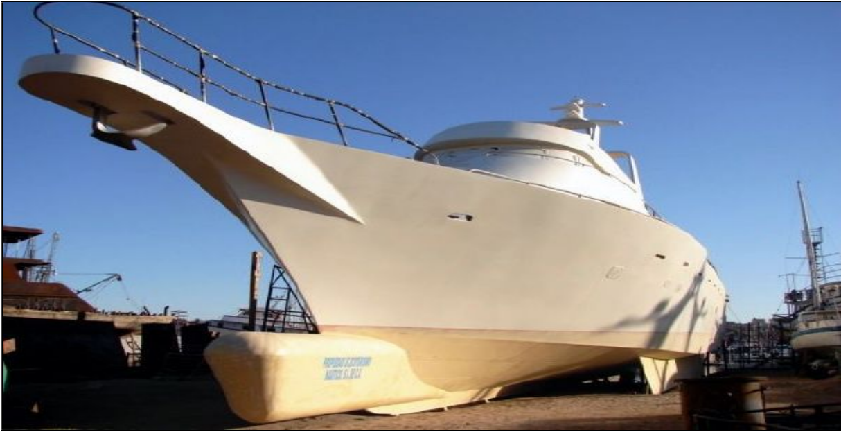
IMAGEN 48: EMBARCACIÓN LISTA PARA LOS TRABAJOS DE PINTURA
