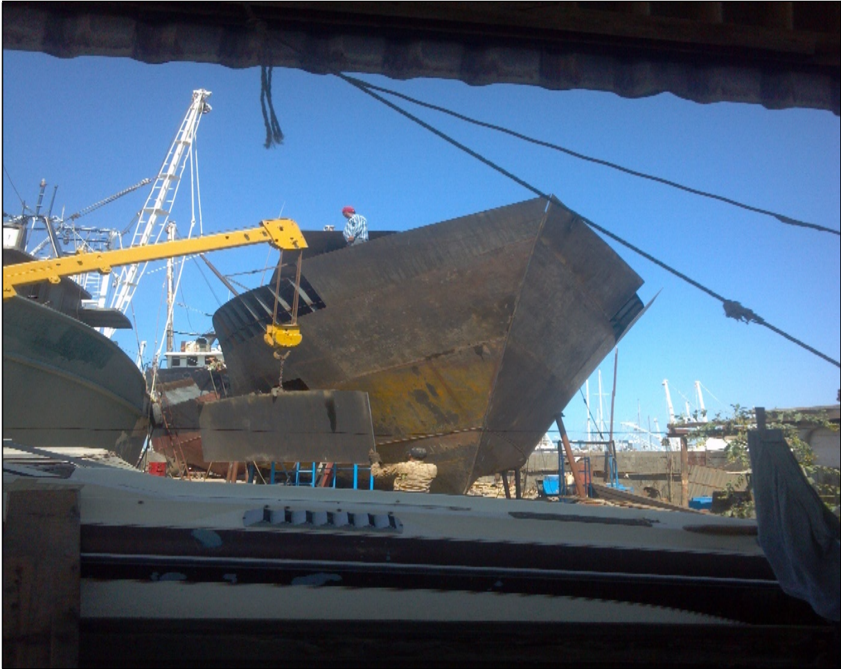
IMAGEN 55: RENOVACIÓN DE ACERO EN EL CASCO DEL BUQUE PESQUERO
