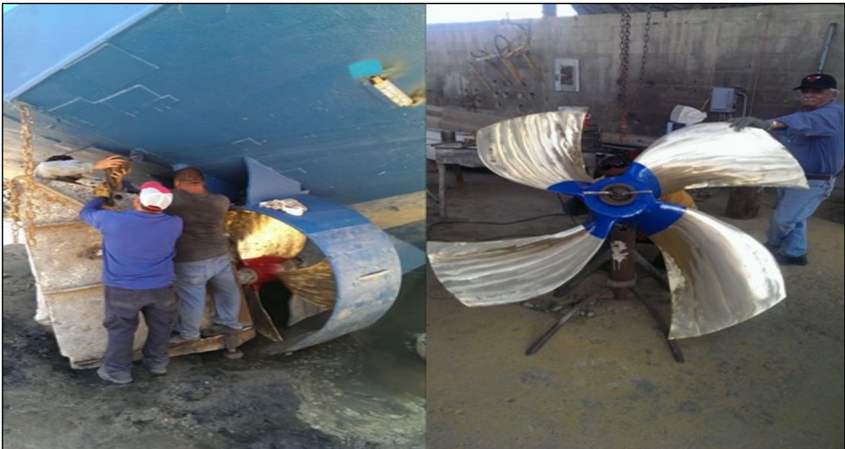
IMAGEN 49: REPARACIÓN DE LA PROPELA DE UNA EMBARCACIÓN
