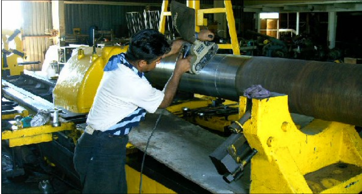
IMAGEN 26: REPARACIÓN DE EJE PROPULSOR
