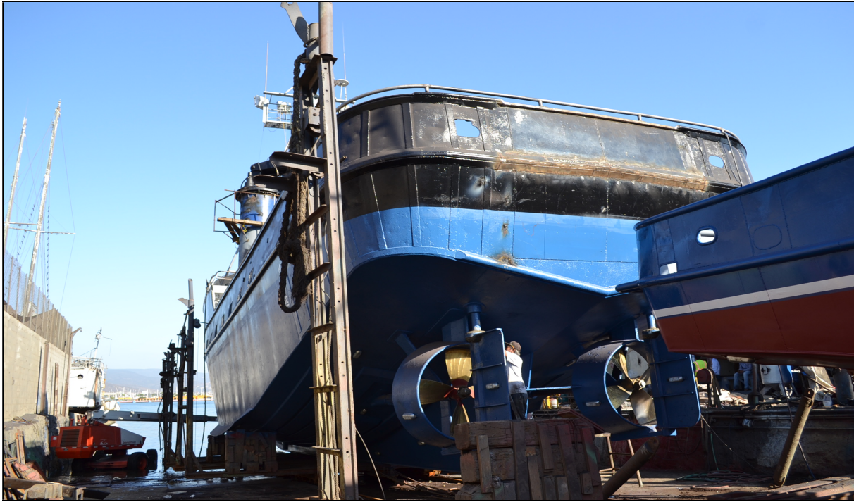
IMAGEN 2: EMBARCACIÓN EN MANTENIMIENTO DEL SISTEMA DE PROPULSIÓN.
