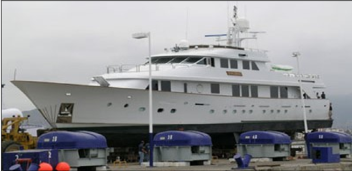
IMAGEN 18: CABESTRANTES DEL DIQUE SINCRONELEVADOR.
