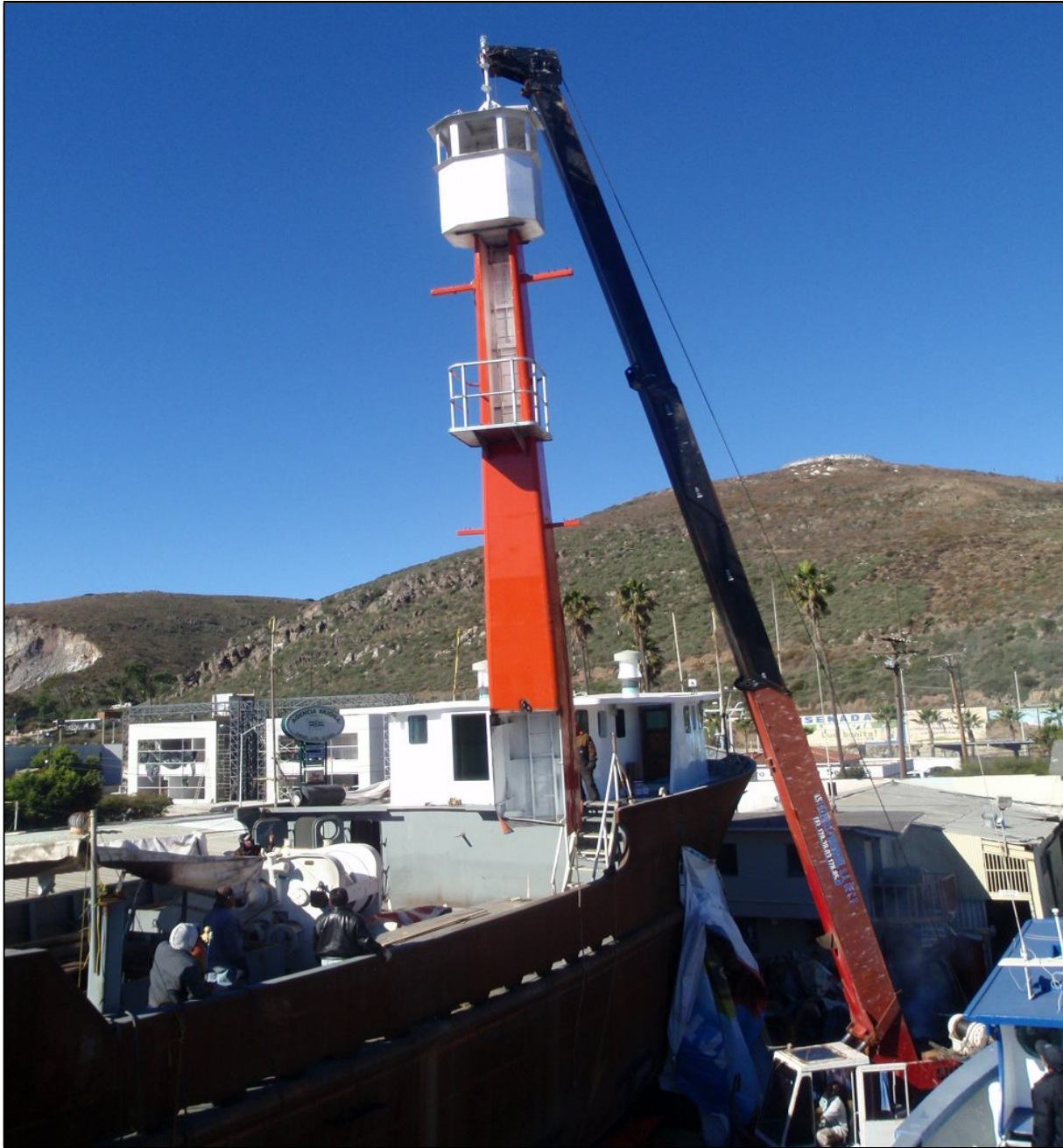
IMAGEN 1: INSTALACIÓN DE COFA DEL PORTOLA VI.
