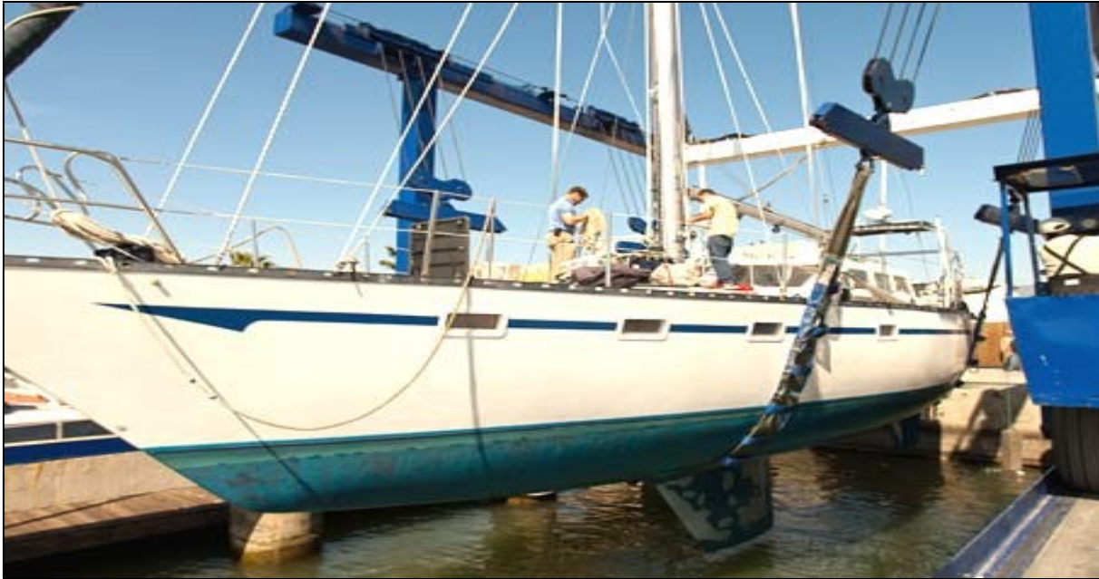
IMAGEN 6: VELERO PUESTO EN SECO POR MEDIO DE LA GRÚA TRAVELIFT.
