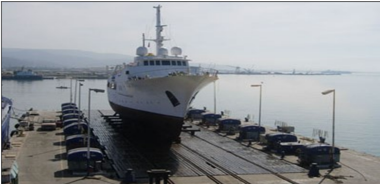
IMAGEN 17: RIELES DE TRANSPORTE PARA FACILITAR EL TRASLADO A LOS TALLERES.
