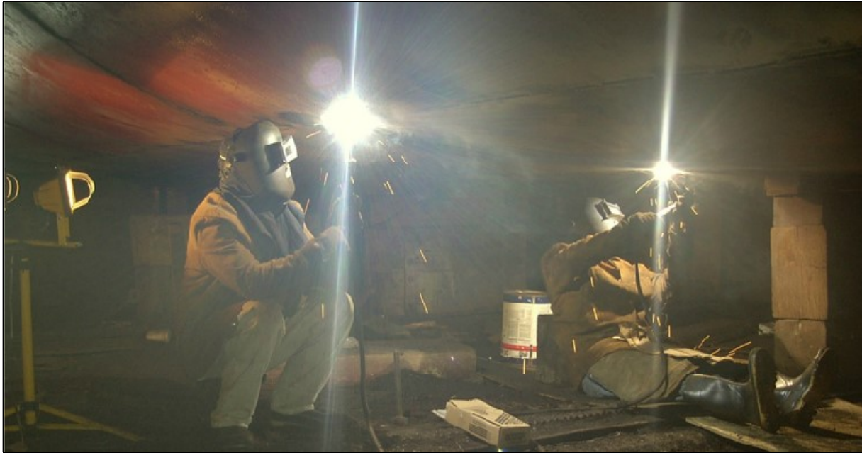
IMAGEN 24: TRABAJO DE SOLDADURA SOBRE LAS PLACAS DEL FONDO EXTERIOR DEL CASCO.
