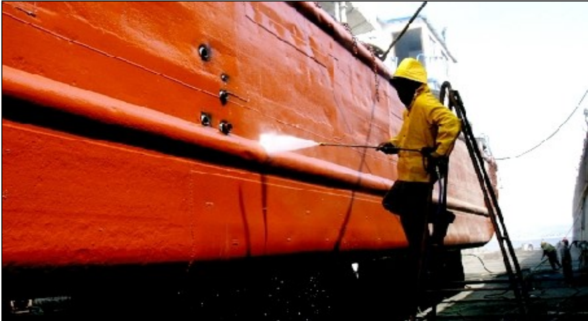
IMAGEN 22: LIMPIEZA SOBRE LA OBRA VIVA DE LA EMBARCACIÓN CON CHORRO DE AGUA.
