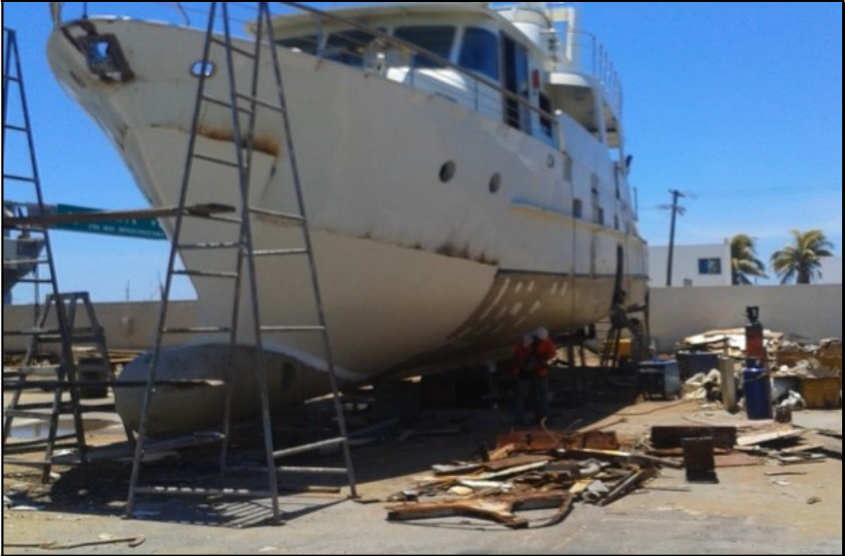
IMAGEN 154: RENOVACIÓN DE ACERO EN EL FONDO DE LA EMBARCACIÓN.
