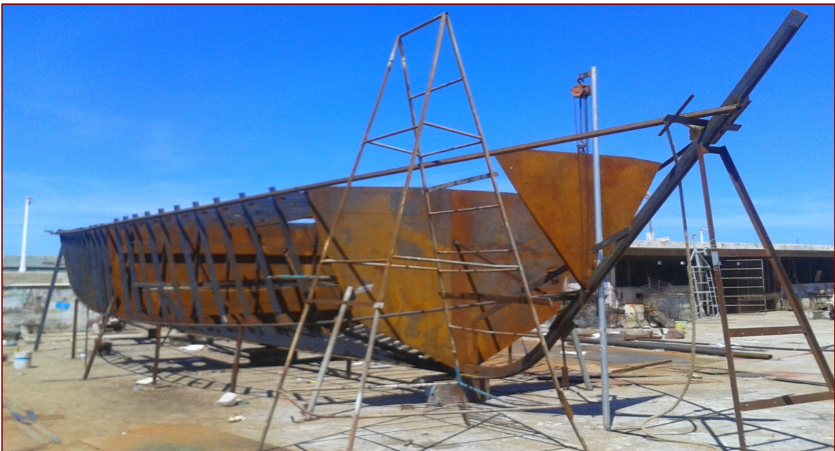
IMAGEN 160: MÉTODO DE CONSTRUCCIÓN TRADICIONAL POR QUILLA.
