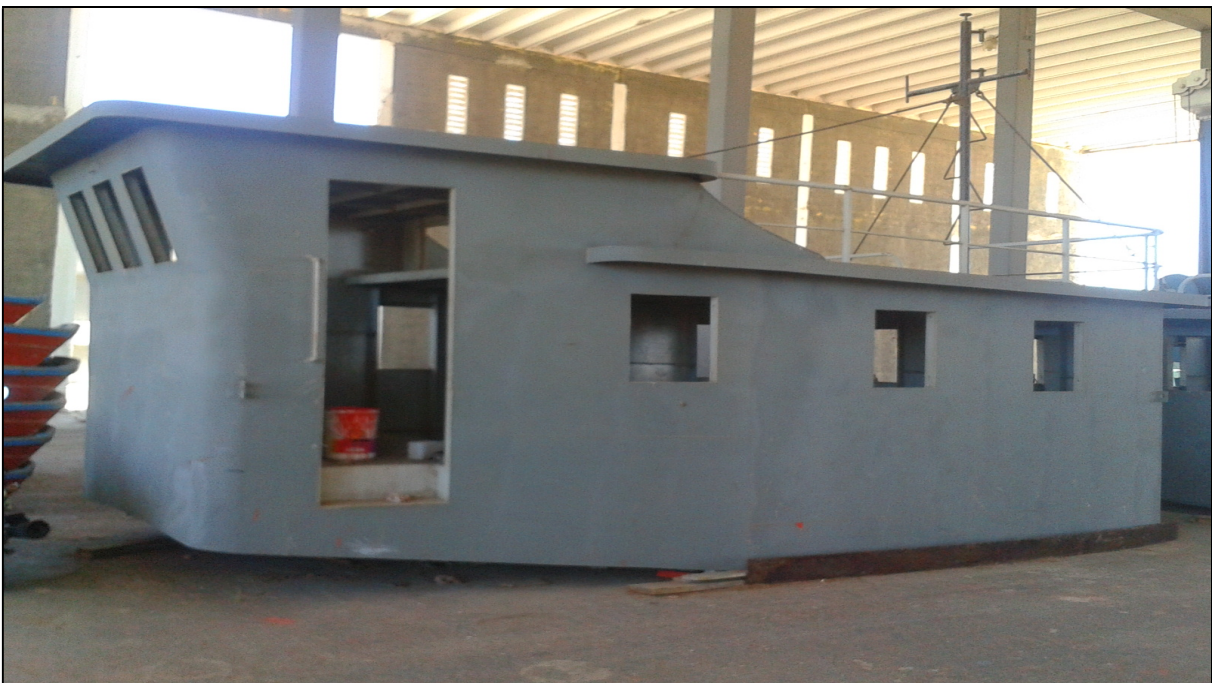
IMAGEN 150: CONSTRUCCIÓN POR BLOQUE DE CASETERÍA DE EMBARCACIÓN DE PESCA.
