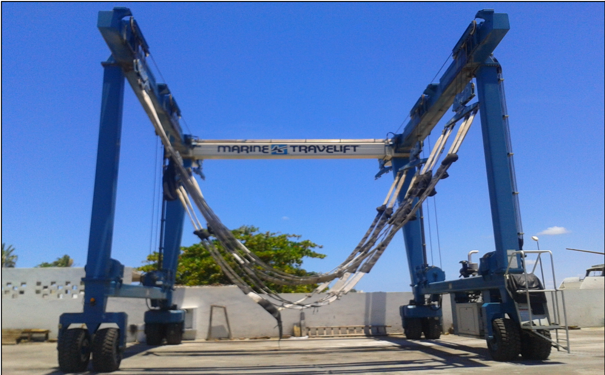
IMAGEN 152: GRÚA TRAVELIFT DE 150 TONELADAS MÉTRICAS.
