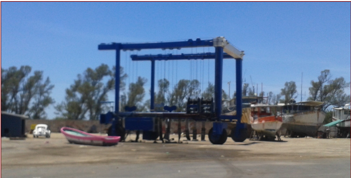
IMAGEN 119: TRAVELIFT DE 110 TONELADAS MÉTRICAS.
