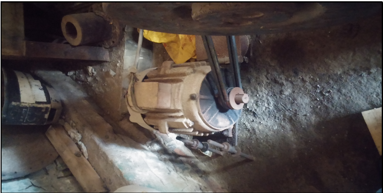
IMAGEN 84: MOTOR ACCIONA EL WINCHE DEL VARADERO.
