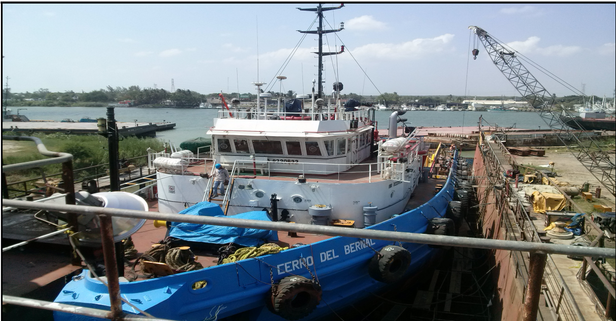
IMAGEN 46: ABASTECEDOR EN DIQUE FLOTANTE PARA REPARACIÓN.
