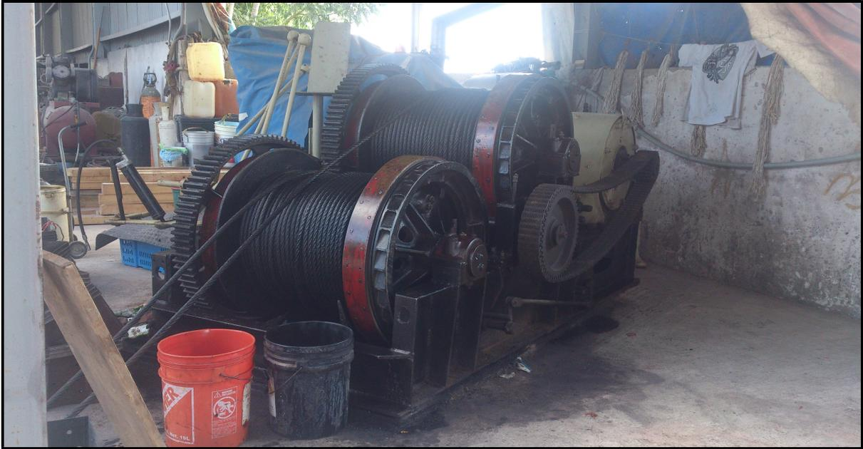
**IMAGEN 33:** WINCHES DE TRACIÓN Y ARRIADO.
