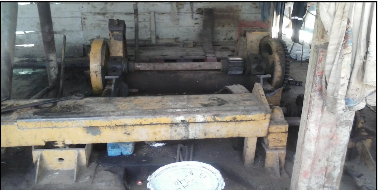
IMAGEN 19: WINCHE DE TRACCIÓN EN REPARACIÓN.
