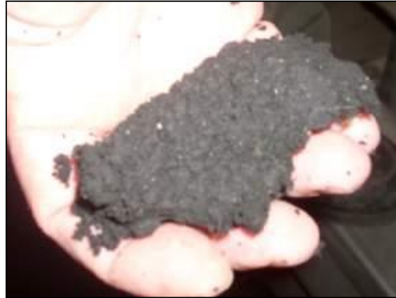
Lodos como efluente tratamiento mecánico (65-75% humedad)
