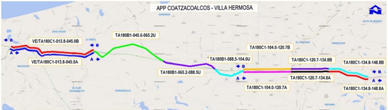
Figura 2. Segmentación del Tramo Carretero en base a Trabajos y Periodos de Ejecución Homogéneos
