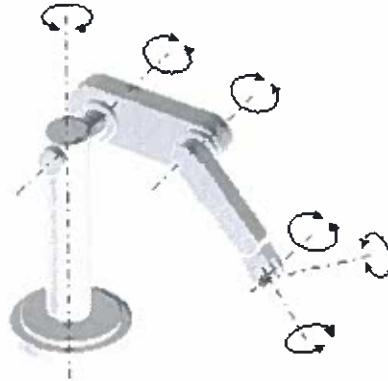
Distintos grados de libertad de un brazo de robot
