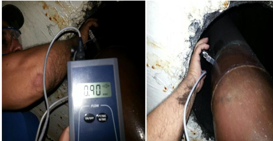
Figura 3. Caracterización de flujos de aceite de temple durante el tratamiento térmico de muelles automotrices.
