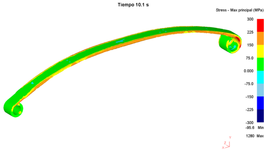
Figura 26. Distribución calculada del esfuerzo máximo principal a 10.1 segundos del inicio del templado en un baño de aceite.
