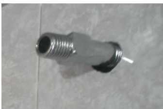
Imagen 12: Colocación del cople
