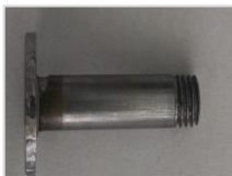
Imagen 3. Tapa Empuje/Tuerca Prensa
