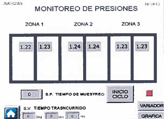
Nota. Valores de Zona 1 y 2 se refiere a saturación de pre filtros en manejadora, colocados para garantizar una prueba en condiciones de aire puro.
