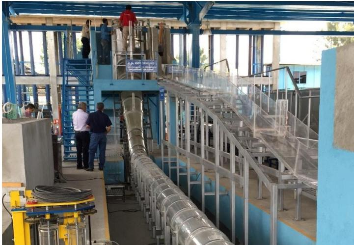
Modelo físico del túnel vertedor existente No. 3
