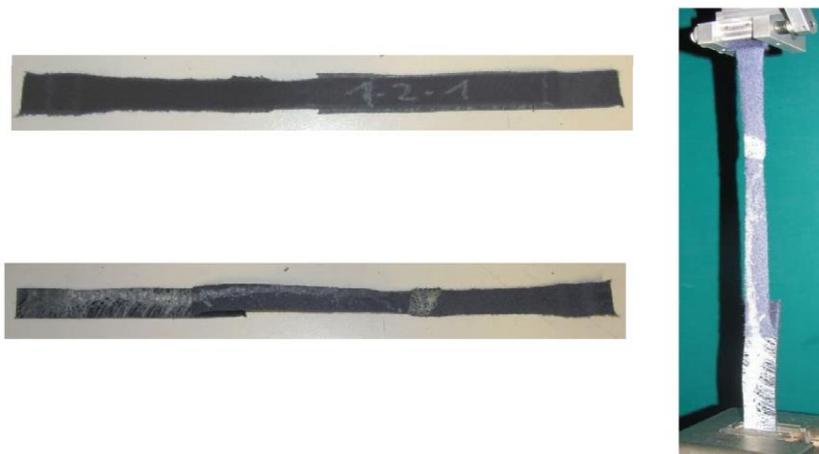
Figura 23: Fotografías de las muestras después del ensayo a T<sup>a</sup> Ambiente.
