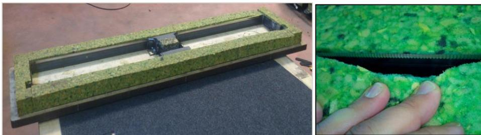
Figura 10: Vista general y detalle del troquel desarrollado para corte del revestimiento.
