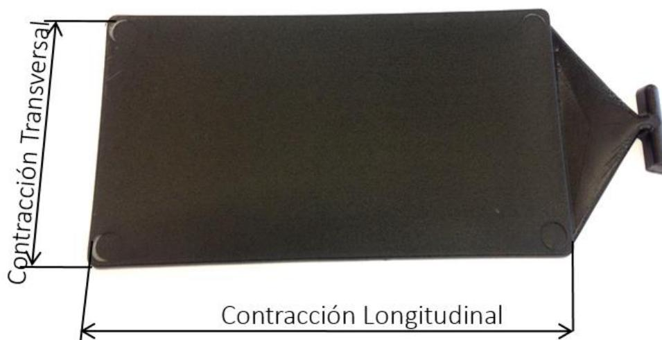
Figura 12: Probeta utilizada para la determinación del coeficiente de contracción.
