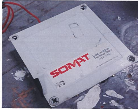
Figura. 12. Representación ilustrativa del módulo de compensación para termopares.
