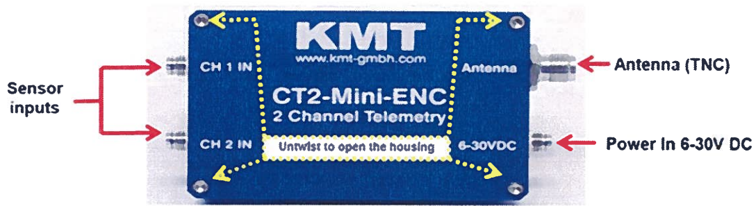
Figura. 1. Representación del equipo de telemetría KMT
