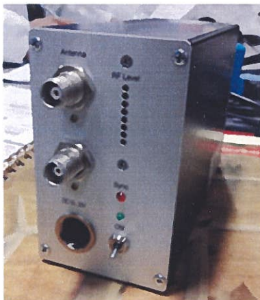
Figura. 6. Decodificador KMT de dos entradas y dos salidas.
