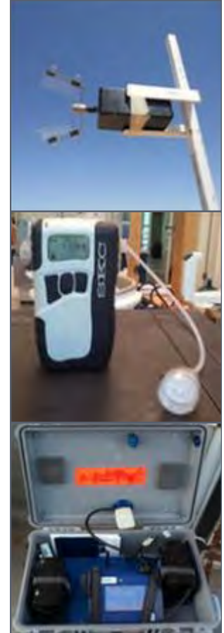
Instrumentos usados para medir PM de las tormentas de polvo, y en los experimentos en calles sin pavimentar.
