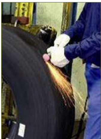
Proceso de recauchutado, uno de los métodos para procesar llantas de desecho.
