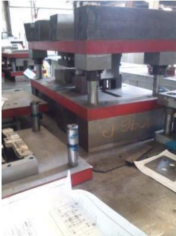
Ilustración 91. Ensamble de un troquel
