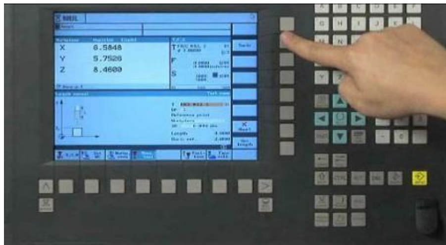
Ilustración 62 Programación manual de máquina CNC.
