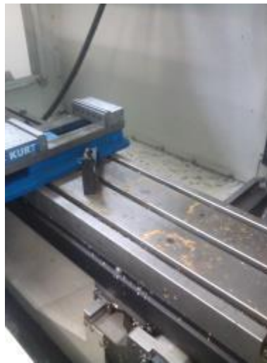
Ilustración 66 Oxido en la maquina
