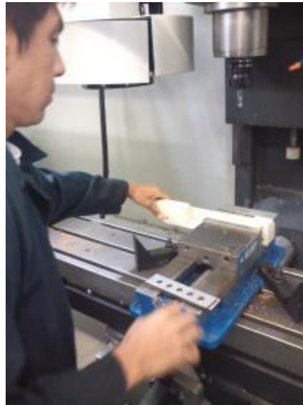
Ilustración 70 Pieza mal colocada
