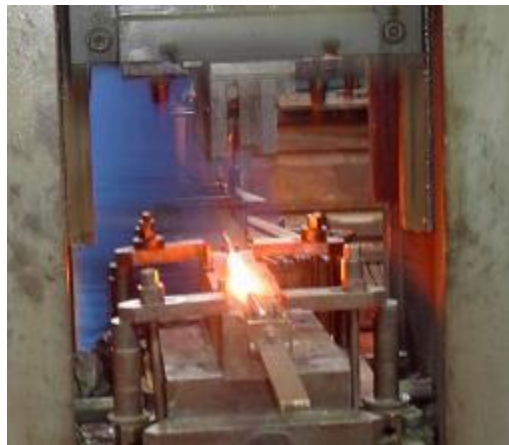
Ilustración 6 Ejemplo de estampación en caliente para piezas automotrices. 8
