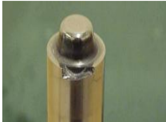
Ilustración 149 Punzón para forja en frío con fractura por fatiga
