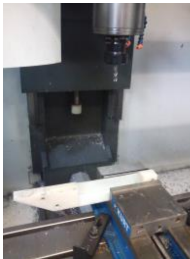
Ilustración 72 Falta de refrigerante
