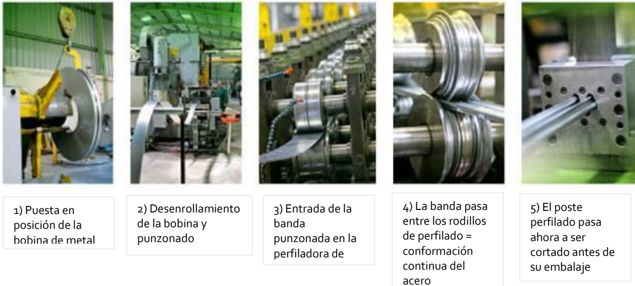
Ilustración 4 Secuencia del proceso de perfilado. 6
