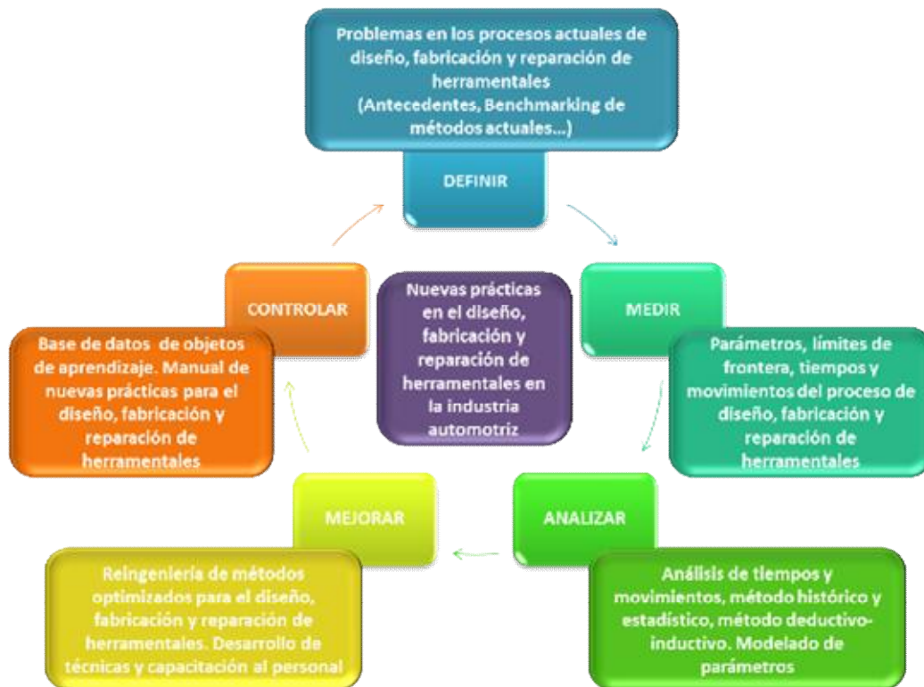
Ilustración 112 Desglose de los pasos de la herramienta DMAIC
