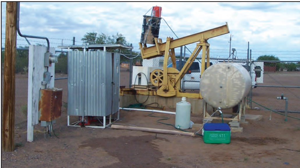
Investigadores de la Universidad Estatal de Arizona prueban un sistema de tratamiento de bajo costo para eliminar arsénico y nitratos del agua subterránea en las tierras de los Tohono O'odham, cerca de Sikul Himatk, Arizona.
