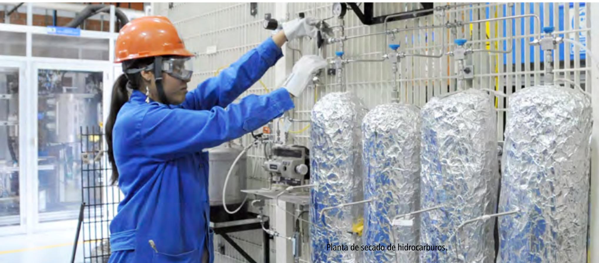
Planta de secado de hidrocarburos.
