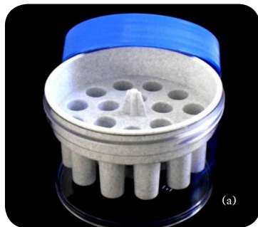
Figura 6.2 Mr. Frosty® de Nalgene (a) y la velocidad ideal de congelación alcanzada (b).
