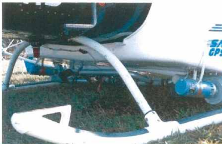
Figura 13 Bomba de aspersión accionada por el sistema eléctrico de la aeronave.
