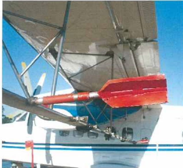
Figura 15. Boquilla del equipo de aspersión de avión.
