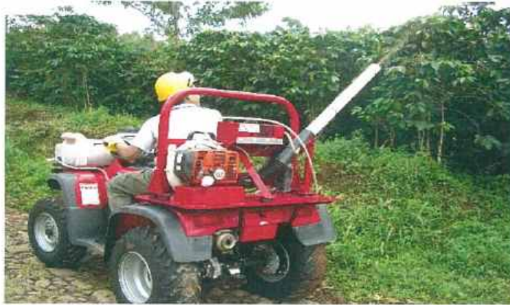
Figura 4. Vehículo tipo cuatrimoto para aspersión terrestre mediante ráfaga.
