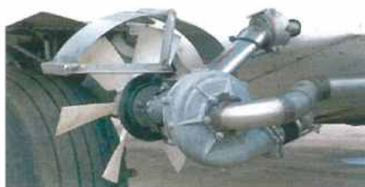
Figura 14. Bomba de aspersión accionada por el viento.
