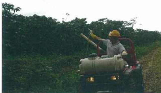
Figura 3. Vehículo tipo cuatrimoto para aspersión terrestre con manguera de 2 m.
