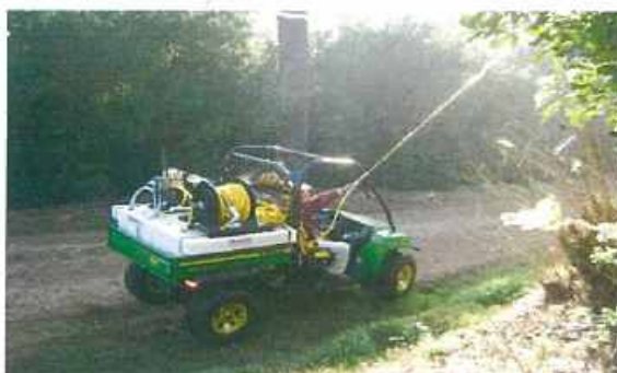
Figura 5. Vehículo vehículos multiuso todo terreno para aspersión terrestre
