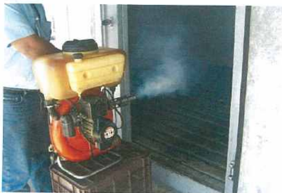
Figura 24. Bomba nebulizadora aplicando humo dentro de una cámara de fumigación.
