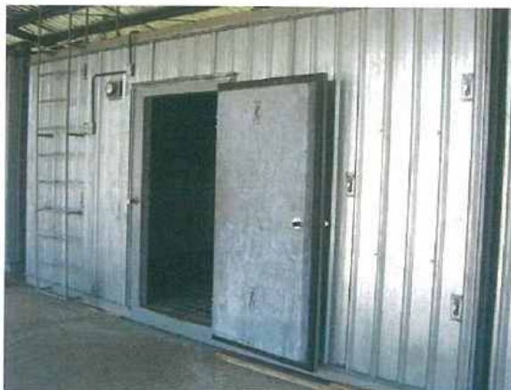
Figura 9. Cámara de fumigación de metal.
